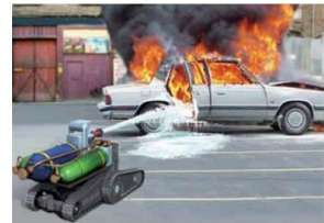
الشكل (٢-١٠): روبوت لمكافحة الحرائق
