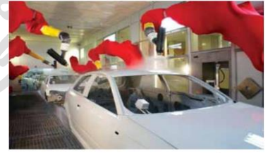
الشكل (٦-٢) : الطلاء باستخدام الروبوت.
